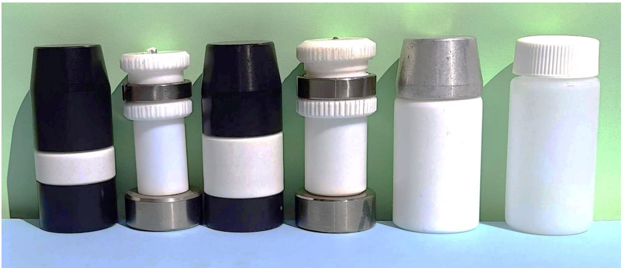
Рисунок 1 – Віали, які використовують у методі на основі РСЛ (зліва направо): 3мл, 3V, 7мл, 7V, 20мл"TF", 20мл"PL"
