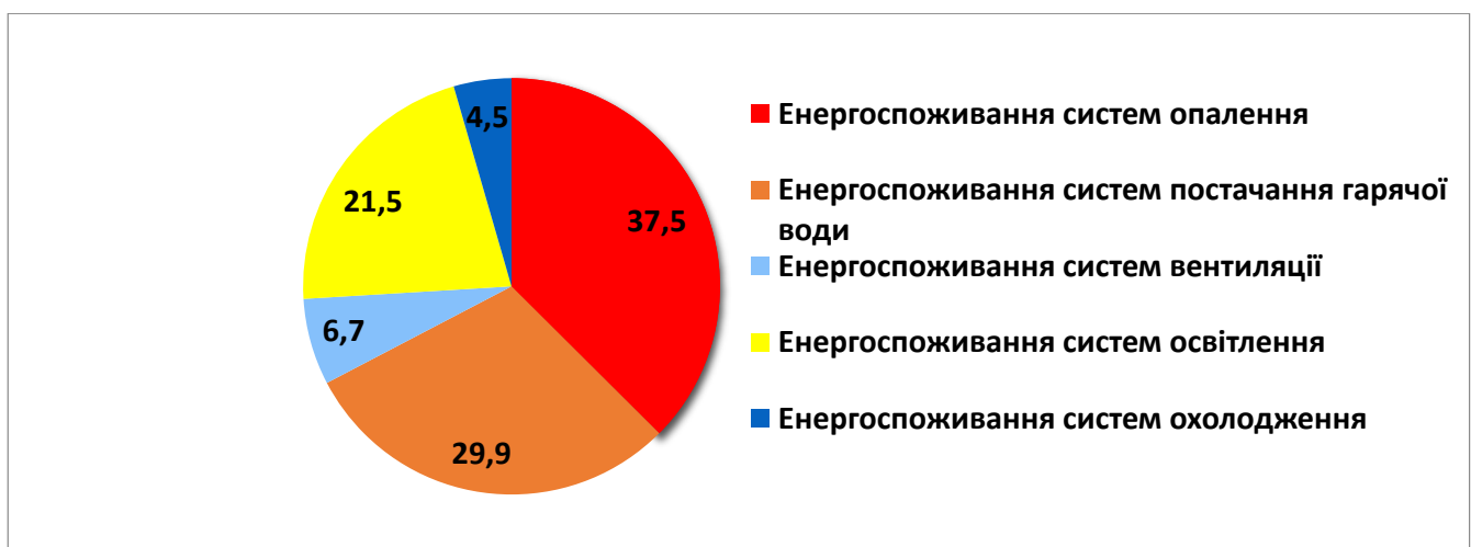
Діаграма річного енергоспоживання будівлі
