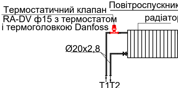
Вузол В. Обв'язка радіатора Hugiene з нижнім підключенням
