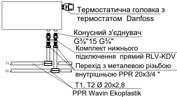
Вузол А. Обв'язка радіатора з нижнім підключенням
