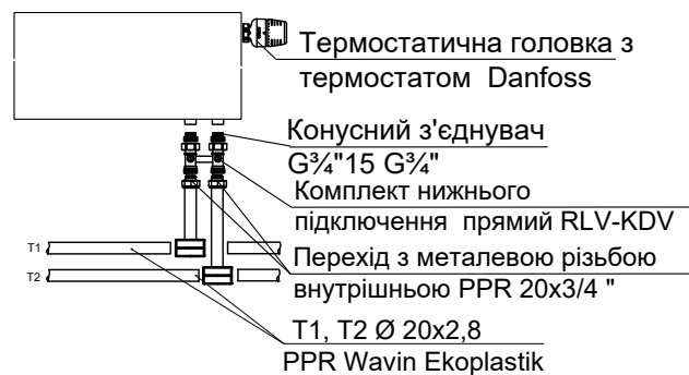
Вузол В. Обв'язка радіатора Hugiene з нижнім підключенням
