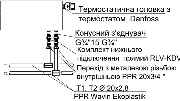
Вузол А. Обв'язка радіатора з нижнім підключенням
