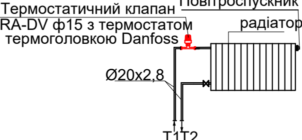
Вузол Б. Обв'язка радіатора з боковим підключенням
