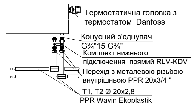
Вузол А. Обв'язка радіатора з нижнім підключенням
